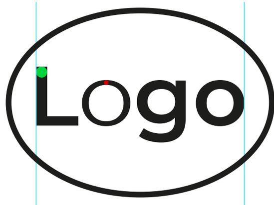
**LEGGENDA:** ● Spessore  $\geq$  a 0,4 cm    ● Spessore  $<$  di 0,4 cm    |    Distanza dai bordi di almeno 5 cm
